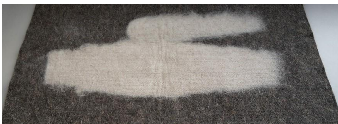
Abbildung | Picture: Definierte Faseranhäufung für Naturfaserhalbzeuge | Defined fibre accumulations for semi-finished products from natural fibre nonwovens © STFI
