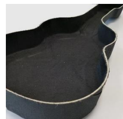
Abbildung | Picture: Definierte Faseranhäufung für Naturfaserhalbzeuge | Defined fibre accumulations for semi-finished products from natural fibre nonwovens © STFI
